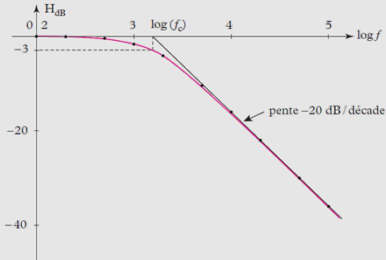
Pour le diagramme de Bode du gain, le choix de l'abscisse ( $\log x$ ,  $\log f$  ou  $\log \omega$ ) ne change pas la forme de la courbe obtenue
