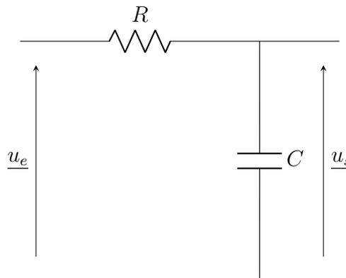
4. On a  $\omega_c = \frac{1}{RC} \Leftrightarrow C = \frac{1}{R\omega_c}$ , par application numérique, on trouve :  $C = 5 \times 10^{-6} \text{ F} = 5 \mu\text{F}$
