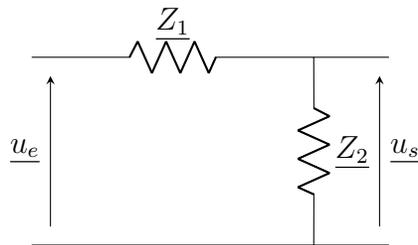
Avec :  $\underline{Z}_1 = R$  et  $\underline{Z}_2 = \underline{Z}_R \parallel \underline{Z}_L$ .
