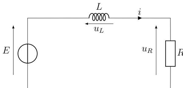
Avant de commencer on note que la bobine est supposée idéale, c'est-à-dire sa résistance interne est nulle.
