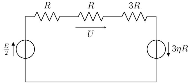
En utilisant diviseur de tension (attention au signe de  $U$  et celui du générateur) :
