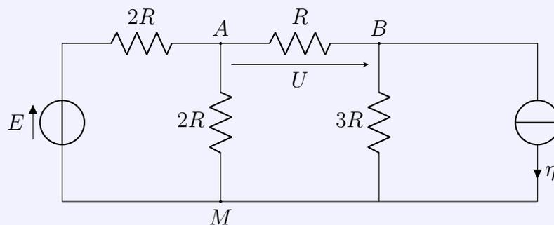
1. Déterminer l'expression de la tension  $U$  entre les points  $B$  et  $A$  en fonction de  $R$ ,  $E$  et  $\eta$  en utilisant la méthode que vous jugez convenable.
