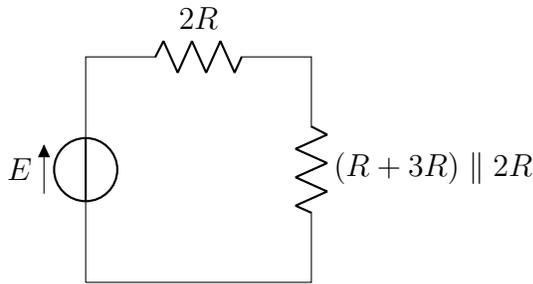
La résistance équivalente est  $R_{eq} = \frac{4}{3}R$ , on applique ainsi le diviseur de tension :
